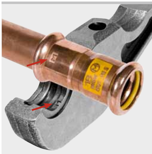
Beispiel REMS Presszange M: Abdruck "M" auf gepresstem Fitting zur Rückverfolgbarkeit gemäß EN 1775:2007
