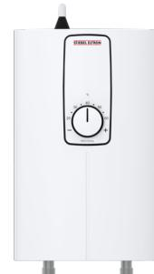
**Komfortmerkmale** • Die 3i-Technologie mit drei Sensoren stellt sicher, dass die Wunschtemperatur bis zur Leistungsgrenze gradgenau erreicht wird. • Durch das Blankdraht-Heizsystem wird das Wasser schnell erwärmt. Die konstante Wunschtemperatur ist durch die elektronische Steuerung sichergestellt. • Die Wunschtemperatur wird manuell über Drehwähler eingestellt.
