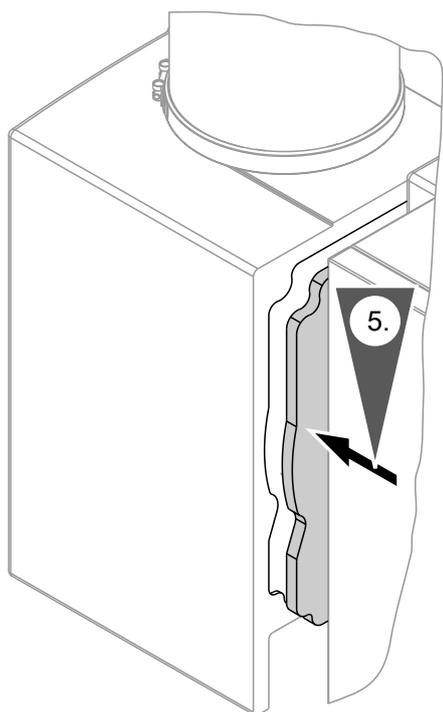
Wärmedämm-Matte in das Gehäuse der Wärmedämmung Wärmetauscher hineindrücken.
