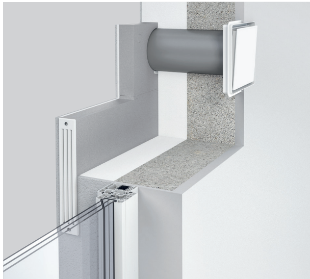
Vitovent 100-D Lüftung in der Fensterlaibung
